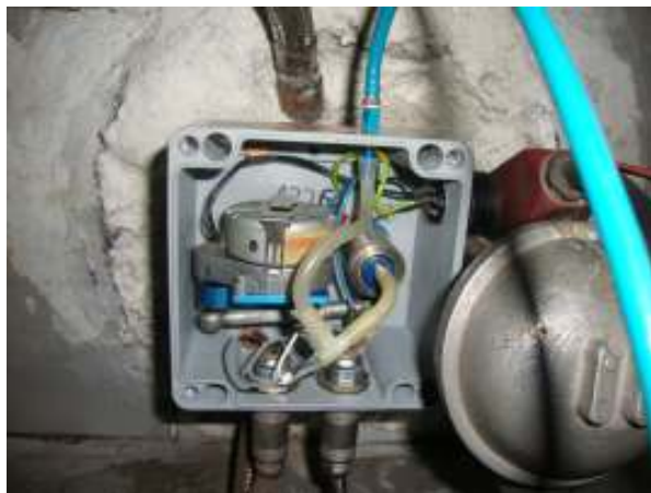
FIGURA 5 - Sonda de Oxigênio instalada no forno
