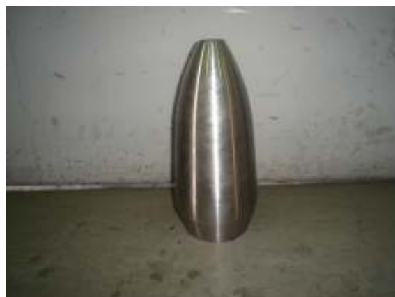
FIGURA 3 - Ponta antes do tratamento térmico
